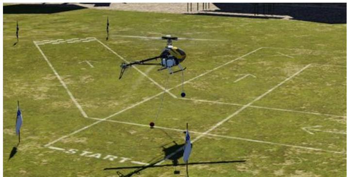
erweiterten Kanaleinstellungen Expo von 0 auf ca. 50 und regeln Sie den Gesamtausschlag (Rate) auf ca. 60% herunter. Sie können auch mit redizierter Drehzahl fliegen, wenn sie den Motor manuell auf einen Kanal legen.
