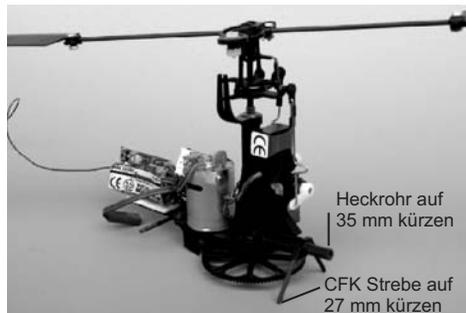
von 27mm, und kleben Sie sie wie beschrieben ein. Sägen Sie vom Heckrohr ein ca. 35mm langes Stück ab, und kleben Sie es, ohne die Kabel des Heckmotors hindurchzuführen, in die Mechanik.
