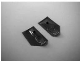
Percez un trou de 1,5mm dans les roues, puis collez les deux parties de chaque roue ensemble. Enfilez un des axes de 1.5mm à travers un des côtés du fuselage. Collez un train d'atterrissage sur l'axe long, et un sur l'axe court ( voir photo ci-dessous). Dégraissez bien les axes avant d'effectuer le collage avec du
