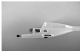
vorsichtig ausschmelzen). Setzen Sie nun zuerst die Unterschalen mit UHU-Por auf. Montieren Sie nun die Räder. Achten Sie darauf, dass die Räder beim einfahren ausreichend
