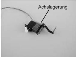
Stecken Sie eine der Achslagerungen auf die Achse und stecken Sie die Achse wie abgebildet in die Befestigungslasche am Servo. Kleben Sie die
