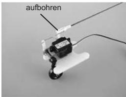
Bohren Sie das äußerste Loch des Servohebels auf 1,5mm auf und stecken Sie den Hebel wie abgebildet senkrecht auf das Servo. Stecken Sie das (kleine)
