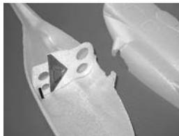
prédécoupée dans le support principal. Découpez ensuite, dans les deux demi coques du fuselage, les orifices pour le passage du rotor principal. Collez le support principal
