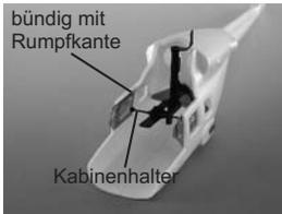
und die Mechanikhalterungen bündig mit der Rumpftrennung abschließen. Markieren Sie die Position der Halter, nehmen Sie die Mechanik heraus und kleben Sie die Halter mit UHU-Por ein. Achten Sie darauf, dass der Rumpf, bei eingesetzter Mechanik leicht unter Spannung stehen muss. Eventuell muss der Kabinenhalter etwas gekürzt werden. Gehen Sie dabei aber äußerst behutsam vor (ohne Vorspannung kann sich die Mechanik unter Umständen im Flug lösen).
