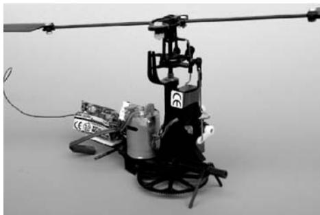
Assemblez la mécanique comme cela est décrit dans le manuel de montage du Piccolo. Laissez de côté l'assemblage des trains d'atterrissage, du moteur principal, et du système d'anticouple. Raccourcissez les tiges de trains d'atterrissage arrière à une longueur de 27 mm , et collez les
