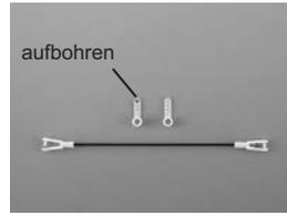
Schieben Sie nun die Hauptfahrwerksachse von links durch den Rumpf und stecken Sie von innen den aufgebohrten Anlenkhebel auf (noch nicht kleben!). Schieben Sie die Achse weiter durch das rechte Loch.
