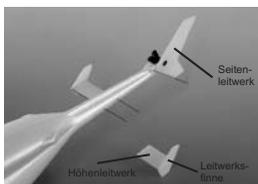
Kleben Sie eine der drei dünnen CFK-Stangen, wie abgebildet, mit Tesafilm an die Seitenleitwerksflosse und kleben Sie das Leitwerk an. Eventuell muss
