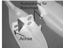
Schneiden Sie nun an beiden Halbschalen mit dem Skalpell die Aussparungen für Rotormast aus. Kleben Sie den Hauptspant mit UHU-Por so in die linke Halbschale, dass er oben
