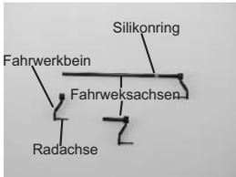
Kleben Sie nun mit CA-Kleber, wie abgebildet, ein Bein auf die Kurze und eins auf die lange Fahrwerksachse.
