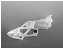
Placez le cockpit sur le fuselage, et veillez à ce que les deux parties s'emboîtent parfaitement. Vérifiez par ailleurs que le palonnier du servo de tangage ait suffisamment de place pour fonctionner librement, et si ce n'est pas le cas, retravaillez les surfaces intérieures avec du papier de verre fin pour libérer l'espace manquant. Ne négligez pas les finitions au papier de verre pour assurer un assemblage propre entre le cockpit et le fuselage.
