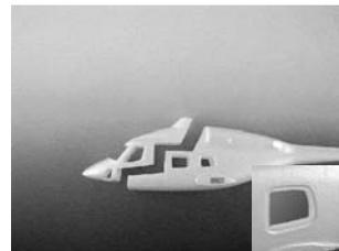
Schneiden Sie, mit dem Skalpell, die Fenster umlaufend 1 bis 2 mm kleiner als die Vertiefungen, aus.
