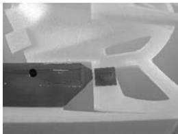
Modifiez maintenant le support du rotor d'anticouple comme sur la photo, en coupant la partie inférieure qui s'enclenche d'ordinaire sur le tube de queue dans le cas de l'utilisation sur un Piccolo standard. Passez ensuite les câbles d'alimentation du moteur d'anticouple dans le fuselage pour les faire ressortir au bon endroit. Ressoudez maintenant les câbles sur le moteur d'anticouple, sans vous tromper dans
