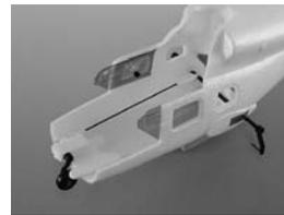
Anlenkhebel auf die Achse (noch nicht kleben). Hängen Sie die Schubstange am hinteren Anlenkhebel ein und kleben Sie nun die ganze Einheit so in den Rumpf, dass das
