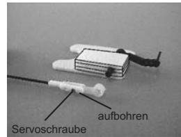
Schubstange ein und fixieren Sie sie, wie abgebildet, mit einer kleinen Schraube. Sie können hierzu z.B. eine der Ersatzschrauben der Piccoloservos
