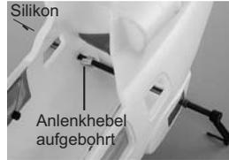
Vermitteln Sie die Achse und sichern Sie sie mit einem zweiten Silikonring.
