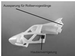
Schneiden Sie an der Haube die Aussparung fürs Bugrad aus. Kleben Sie die zwei
