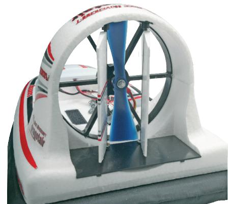
Schneiden Sie an der gezeigten Stelle ein Stück aus dem Spant aus, so dass die Motorkabel hier Platz haben.
