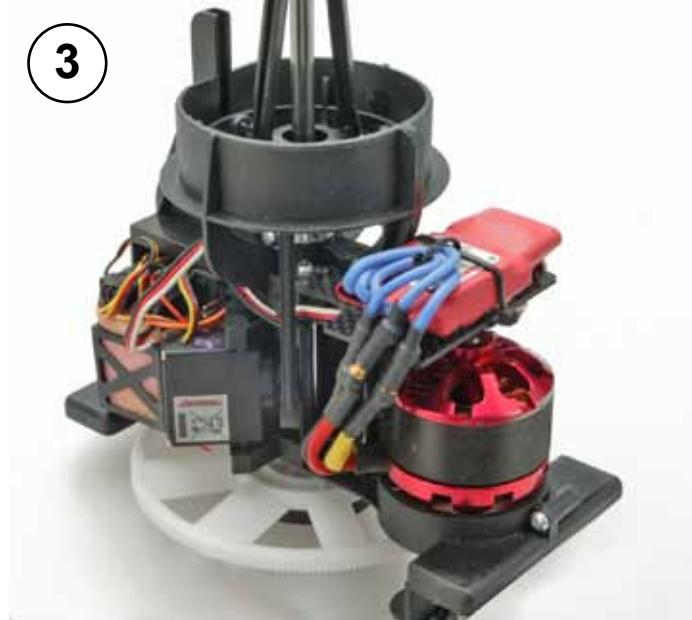
! Fixieren Sie sämtliche Kabel mit Kabelbindern. Achten Sie darauf, dass keine Kabel in Bewegliche Teile geraten können. !
