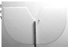
13.) Schieben Sie so dann das fertige Seitenleitwerk über das Höhenleitwerk, sodaß sich die Ruderklappen um ca. +/- 30° bewegen lassen, und kleben Sie es mit Styroporkleber fest.
