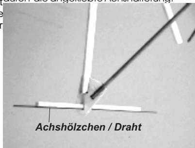
5.) Fädeln Sie das Achshölzchen und das Drahtstück durch die zweite Achshalterung und verkleben diese mit der Fahrwerkshalterung und der Verstrebung. Verkleben Sie anschließend die Verstrebung mit dem Rumpfstab. Damit ist das Fahrwerk fertig.
