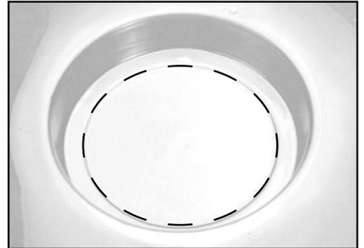
Zum Trimmen der Unterschale ritzen Sie mit einem Skalpell von der Innenseite exakt dem Absatz entlang. Da die Unterschale aus ABS Kunststoff besteht, können Sie nun das überschüssige Material einfach durch Knicken entfernen.
