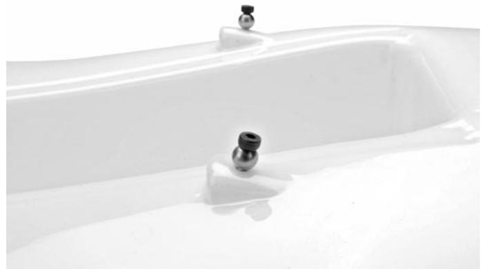
Anschließend die M2 Gewindestangen in die Kugelpfannen drehen und durch die CFK Rohre stecken. Auf das herausstehende Ende eine U-Scheibe und ein Silikonstück (9 mm lang) aufschieben und durch die Langlöcher im Spant stecken. Auf der anderen Seite eine selbstsichernde Mutter aufdrehen (noch nicht festziehen). Die Gewindestange muss nun so weit gebogen werden, bis die Kugelpfanne auf der Messingkugel eingeklipst werden kann.
