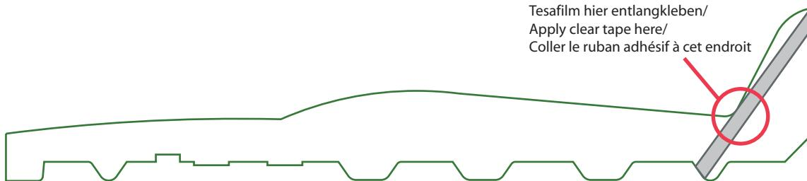
Um die Stabilität des Seitenleitwerks zu erhöhen, kann vor dem Verkleben der Rumpfteile beidseitig je ein Streifen Tesafilm wie in der Zeichnung dargestellt aufgebracht werden.
