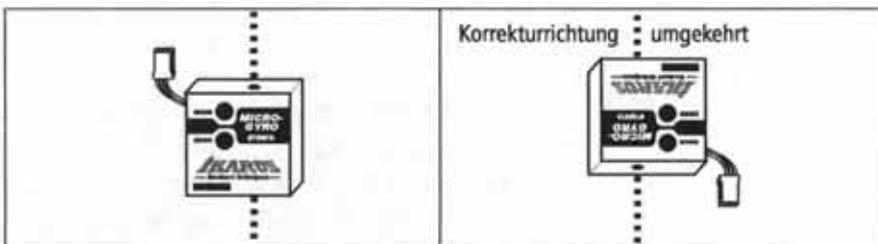
Steuert das Ruder in die falsche Richtung, so muss der Gyro quer zur Korrekturachse um 180° gedreht (auf den Kopf gestellt) werden.
