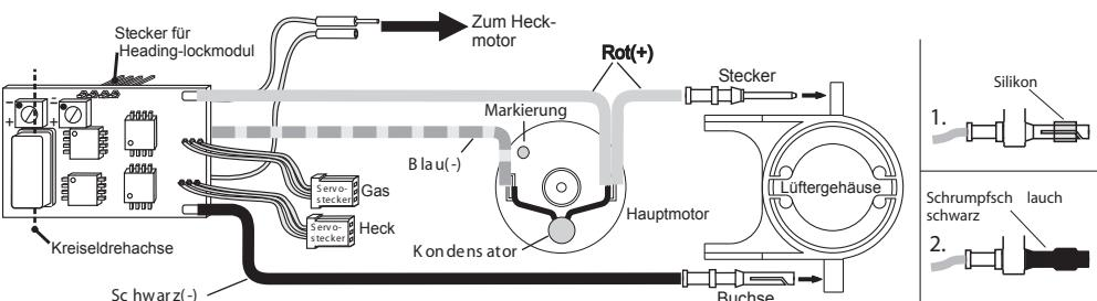
Um beim Einstellen der Elektronik ein Anlaufen des Hauptmotors zu vermeiden, kann das blaue Kabel vom Motor getrennt werden. In jedem Fall muß bei Einstellarbeiten der Motor mechanisch entkoppelt sein! (Motorritzel entfernen)
