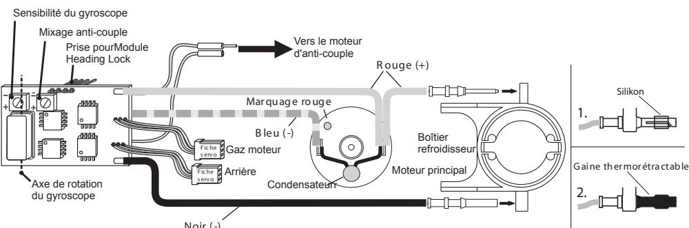
Lors du montage du Board sur votre hélicoptère, veillez à ce que l'axe de rotation du gyroscope soit parallèle à l'axe du rotor principal.
