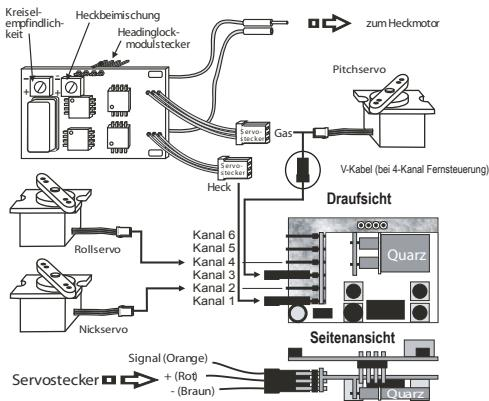
Das Piccoboard PRO verfügt über 2 Trimppots zur Einstellung von Kreiselempfindlichkeit und Stärke der Heckbeimischung. Abgebildet ist die Werkseinstellung der Pots: Kreiselempfindlichkeit voll aufgedreht, Heckbeimischung auf ca. 3/4 des Weges (jeweils im Uhrzeigersinn).
