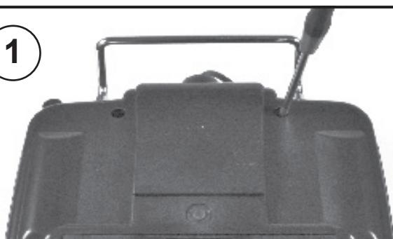
Lösen Sie die 4 Schrauben an der Gehäuseunterseite und entfernen Sie den Gehäuseboden.
