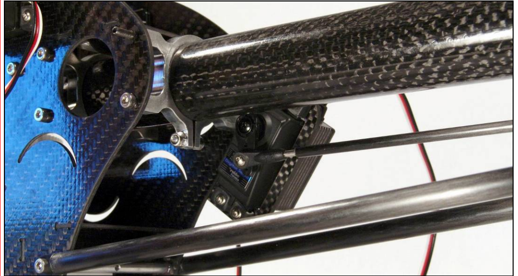
Bild zeigt montiertes Heckrotorservo S9251
