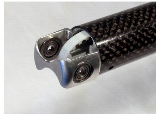
Bild zeigt montiertes Heckrotorgehäuse
