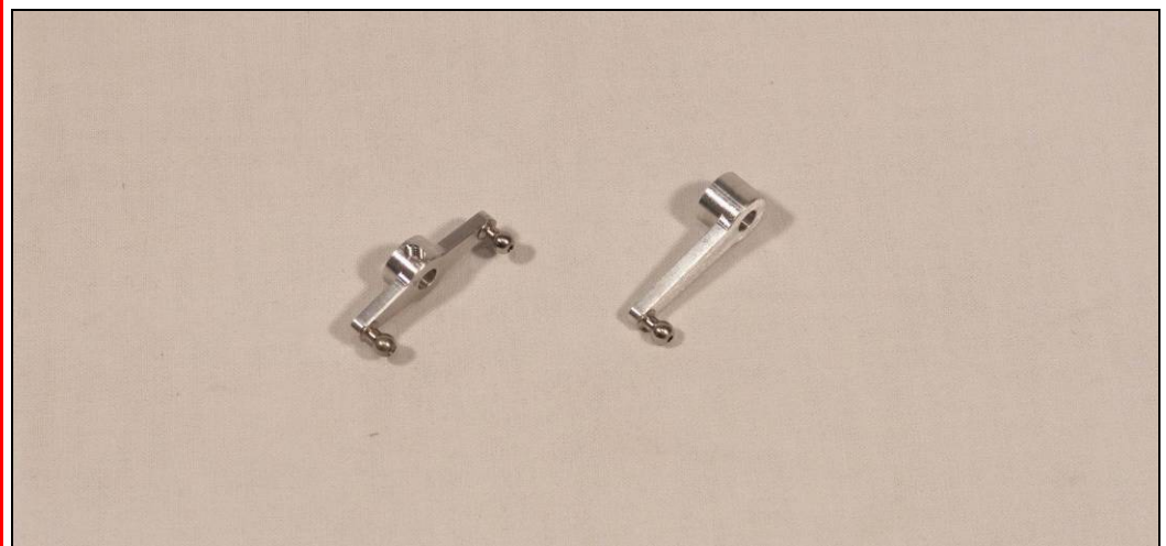
Bild zeigt die fertig montierten Nickhebel
