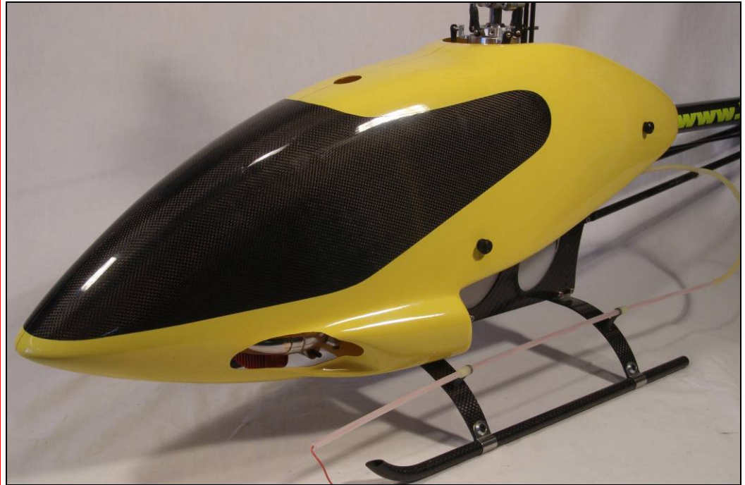
Bild zeigt Ausschnitt für Dämpfer bzw. Resorohrsystem der linken Seite
