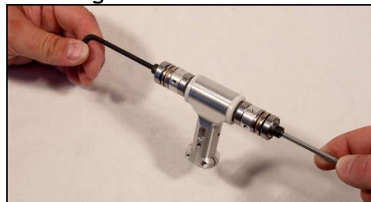
Bild zeigt das Festziehen der Blattlagerwellenverschraubung
