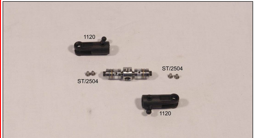
Bild zeigt Aufbau zu montierende Heckblatthalter
