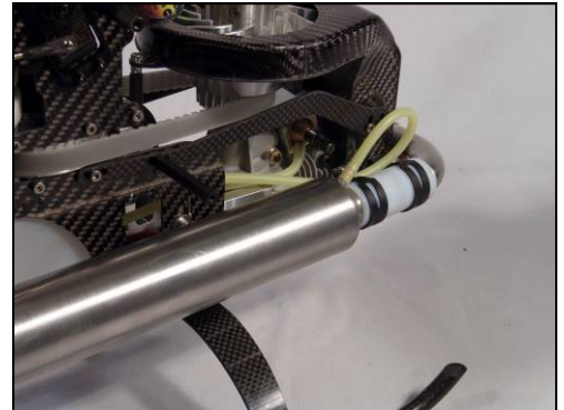
Bild zeigt montierte Treibstoffleitungen
