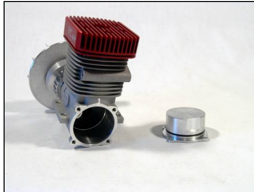
Bild zeigt demontierten Kurbelwellengehäusedeckel
