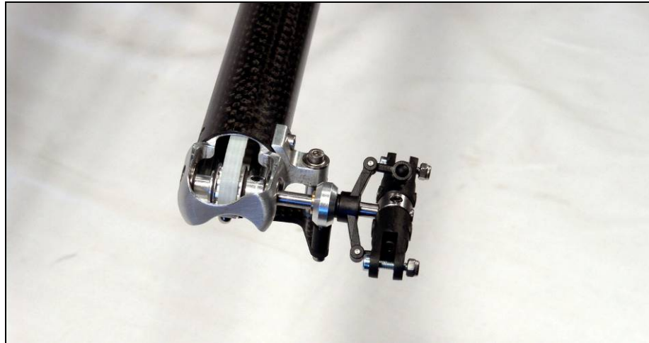
Bild zeigt montierten Heckrotor
