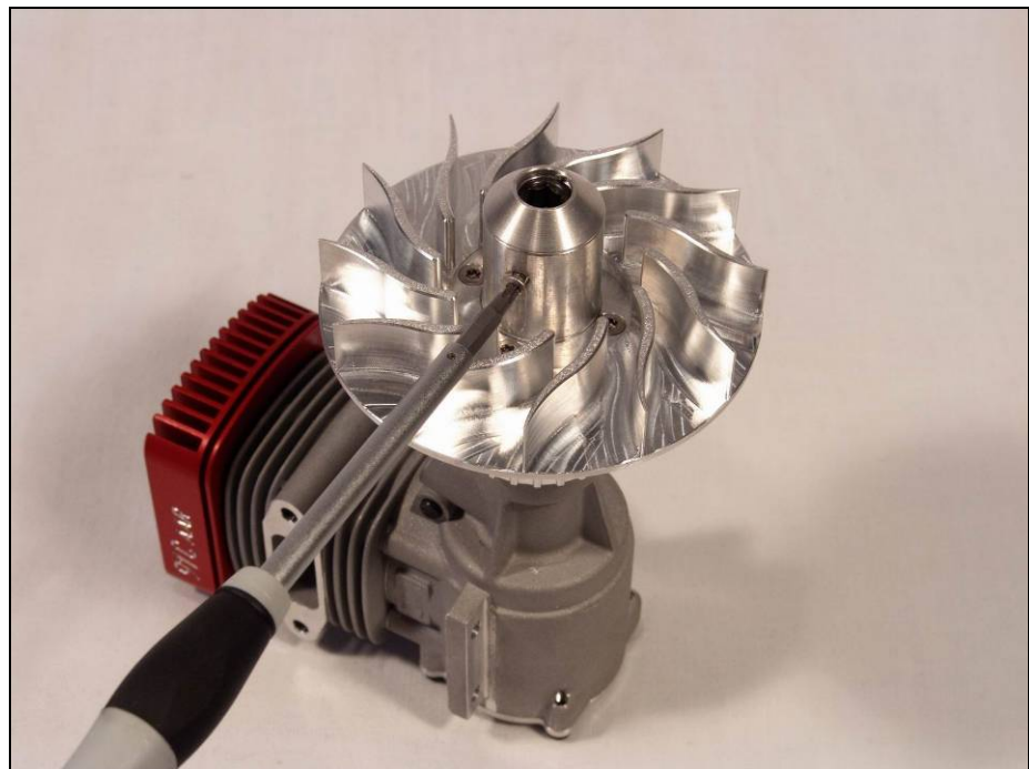
Bild zeigt zu montierende Lüfterradeneinheit
