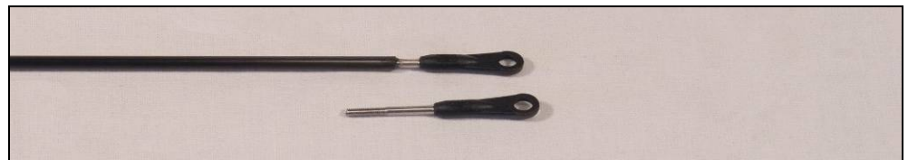
Bild zeigt eingeklebtes Gestänge und montiertes Kugelgelenk
