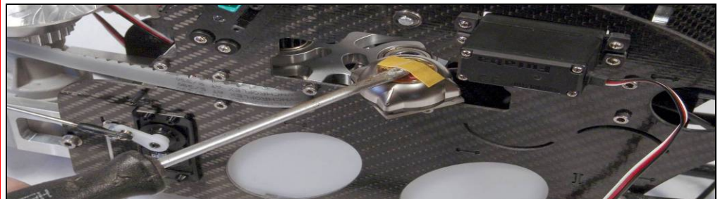
Bild zeigt zu montiertes Kreiselement GY-6
