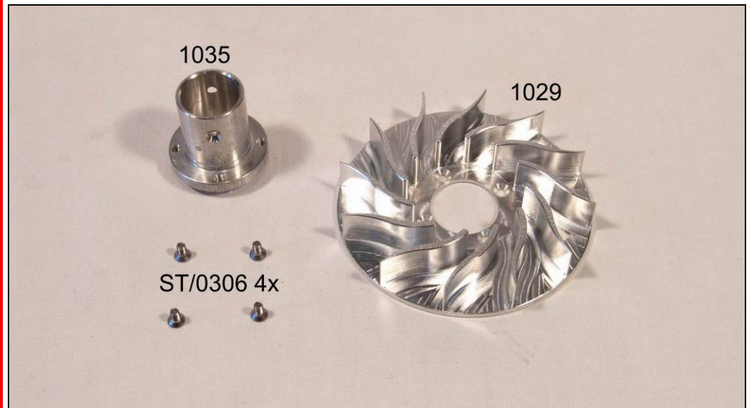
Bild zeigt Einzelteile der Lüfterradeneinheit
