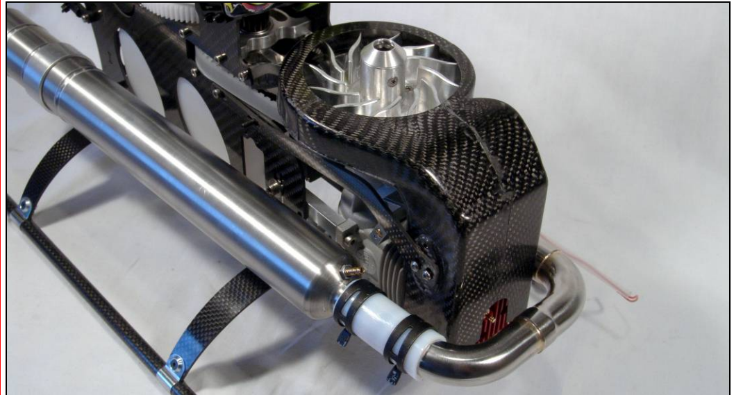
Bild zeigt montierten Gebläseschacht
