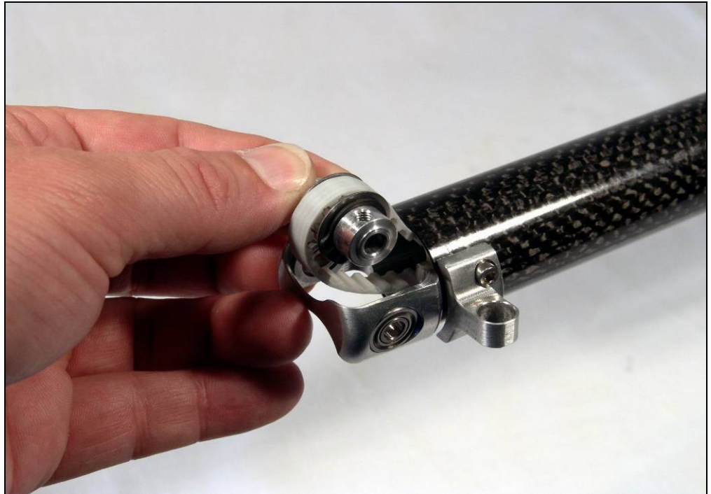
Bild zeigt Montage des vormontierten Riemenrades
