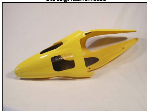
Bild zeigt Öffnung Kühlluftauslass
