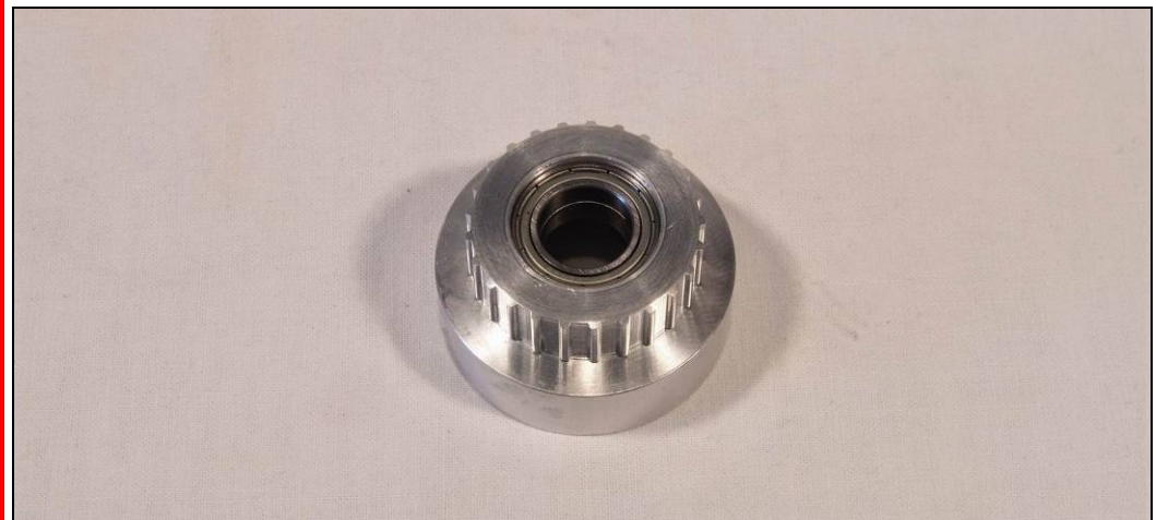
Bild zeigt fertig montierte Kupplungsglocke
