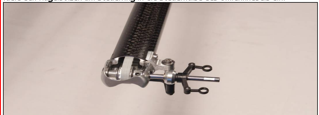
Bild zeigt montierte Hecksteuerbrücke
