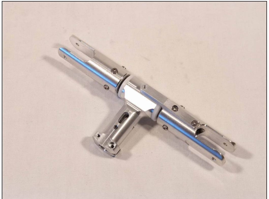
Bild zeigt montierten Blatthalter und Anlenkarm
