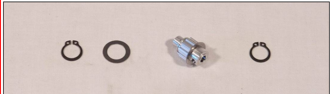
Bild zeigt montierte Passscheibe 12x18x0,5
