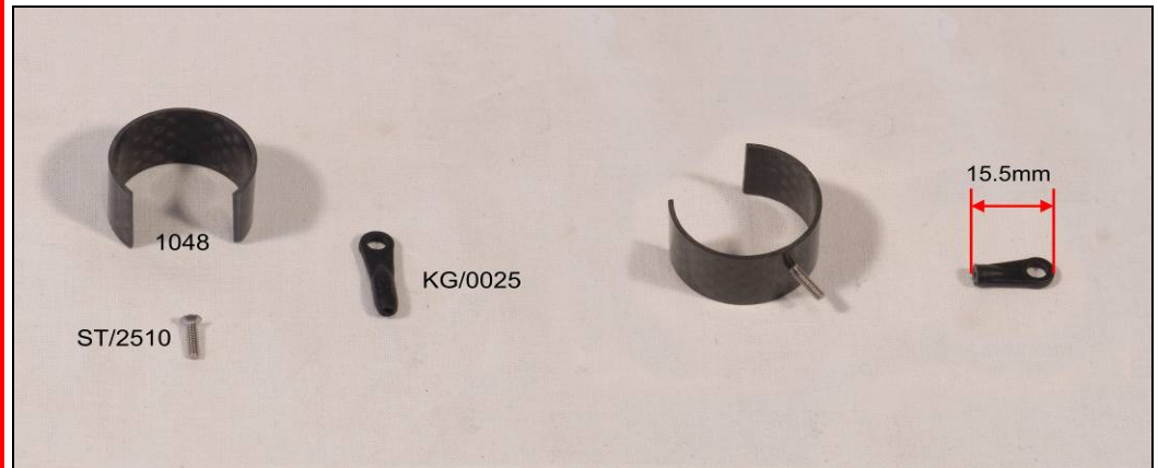
Bild zeigt die Vorbereitung des Kohlerohres 30x20, sowie des Kugelgelenkes
