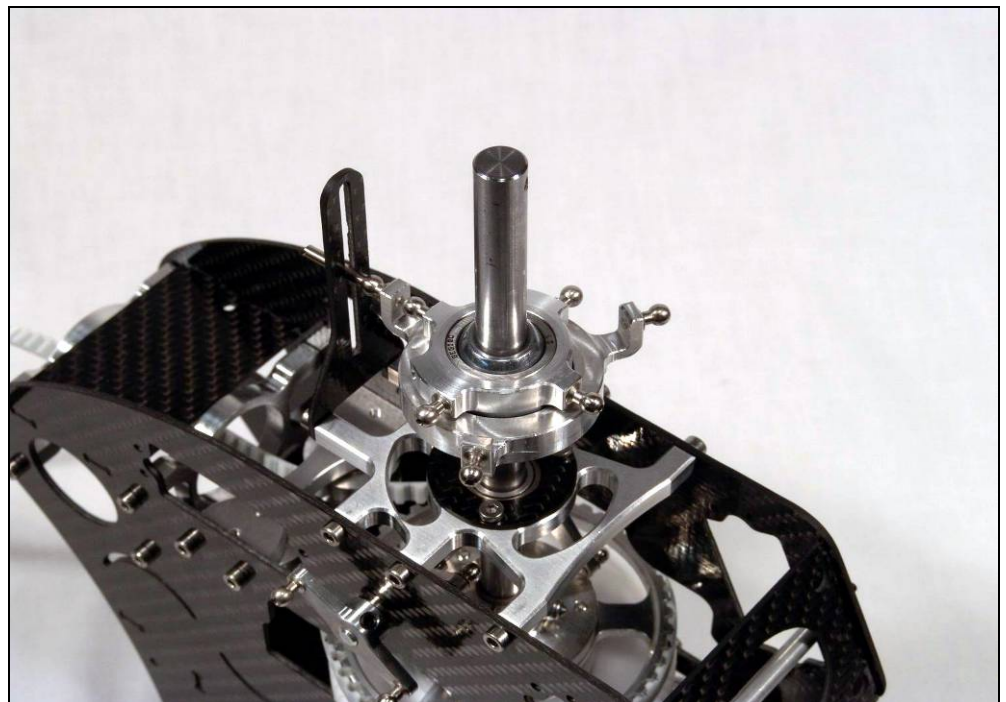
Bild zeigt montierte Taumelscheibe
