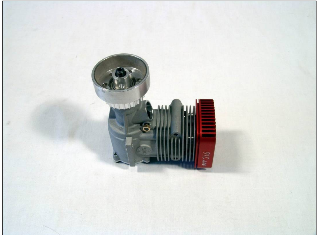
Bild zeigt montierte Kupplungsglocke
