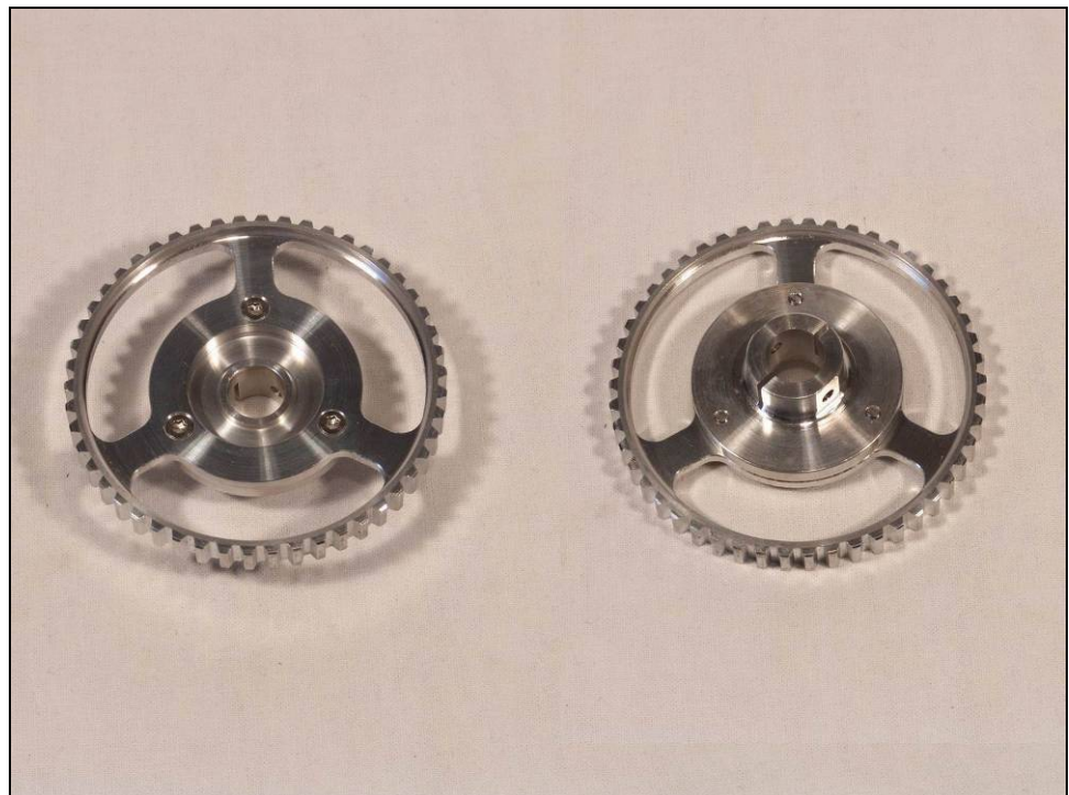
Bild zeigt fertig montiertes Riemenrad von unten
