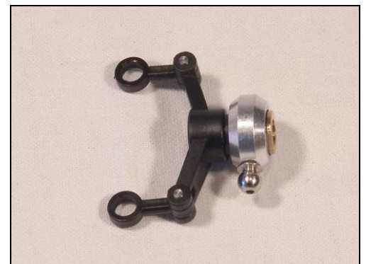
Bild zeigt montierte Pitchbrücke
