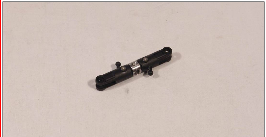
Bild zeigt Aufbau zu montierte Heckblatthalter
