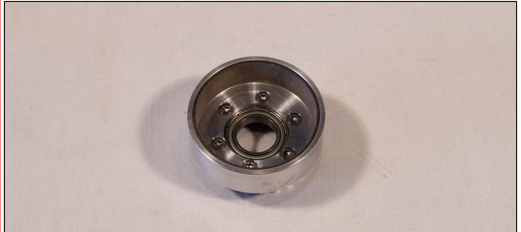
Bild zeigt montierte Kupplungsglocke am Riemenrad
