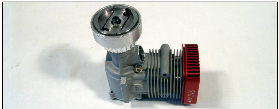
Bild zeigt montiertes Fliehgewicht
