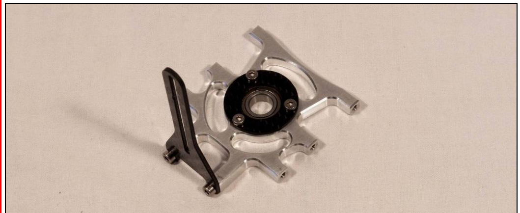
Bild zeigt montierte Taumelscheibenführung
