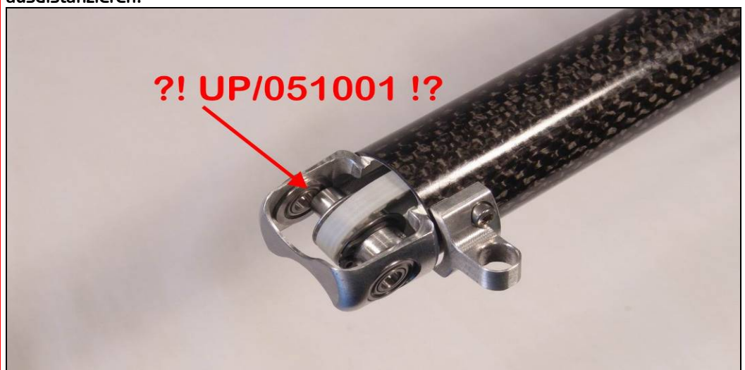
Bild zeigt montiertes Riemenrades
