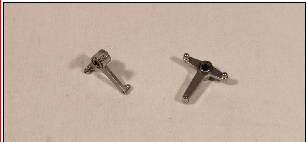
Bild zeigt die fertig montierten Rollhebel
