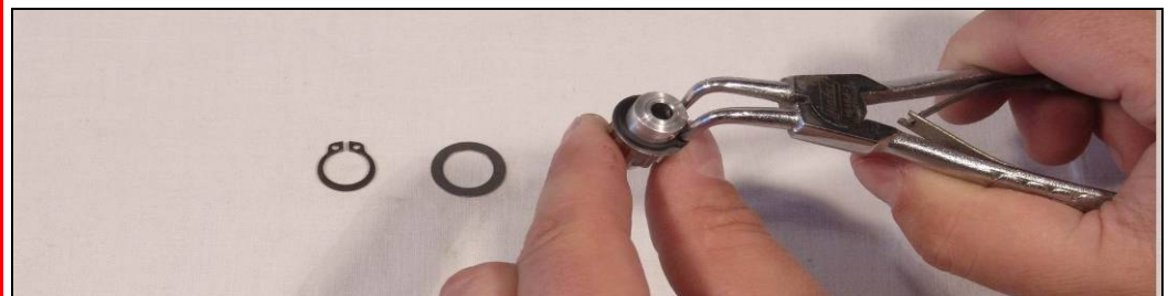
Bild zeigt Montage Sicherungsring
