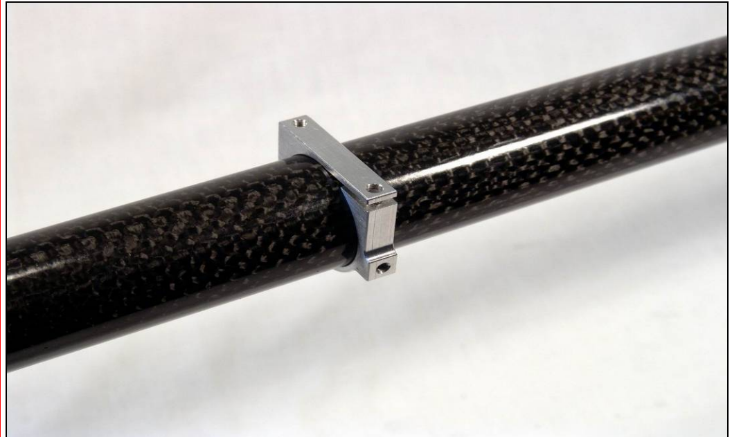
Bild zeigt montierten Höhenleitwerkshalter
