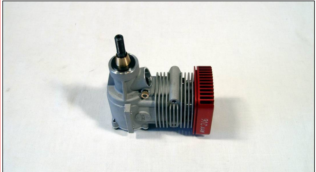
Bild zeigt montierten Spannkonus
