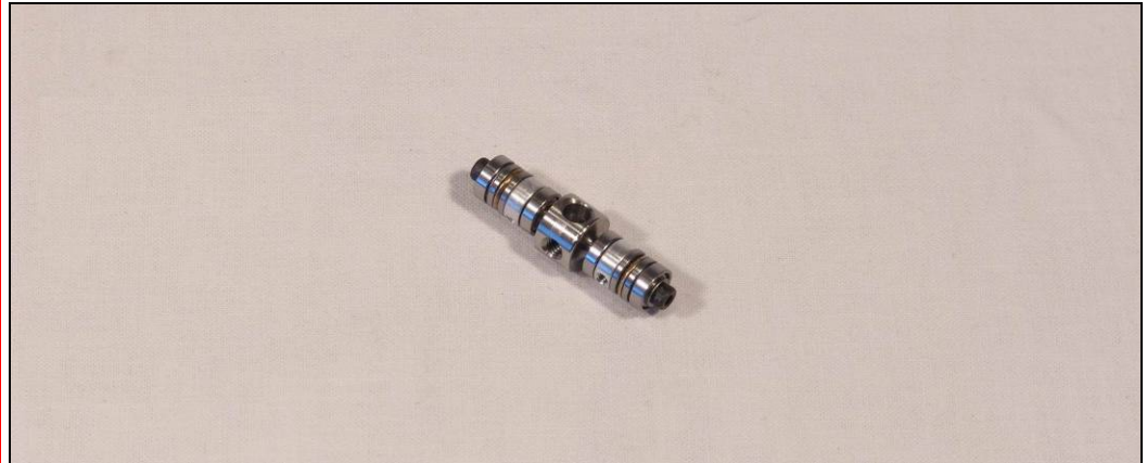
Bild zeigt Aufbau der Lagerung des Heckblatthalters
