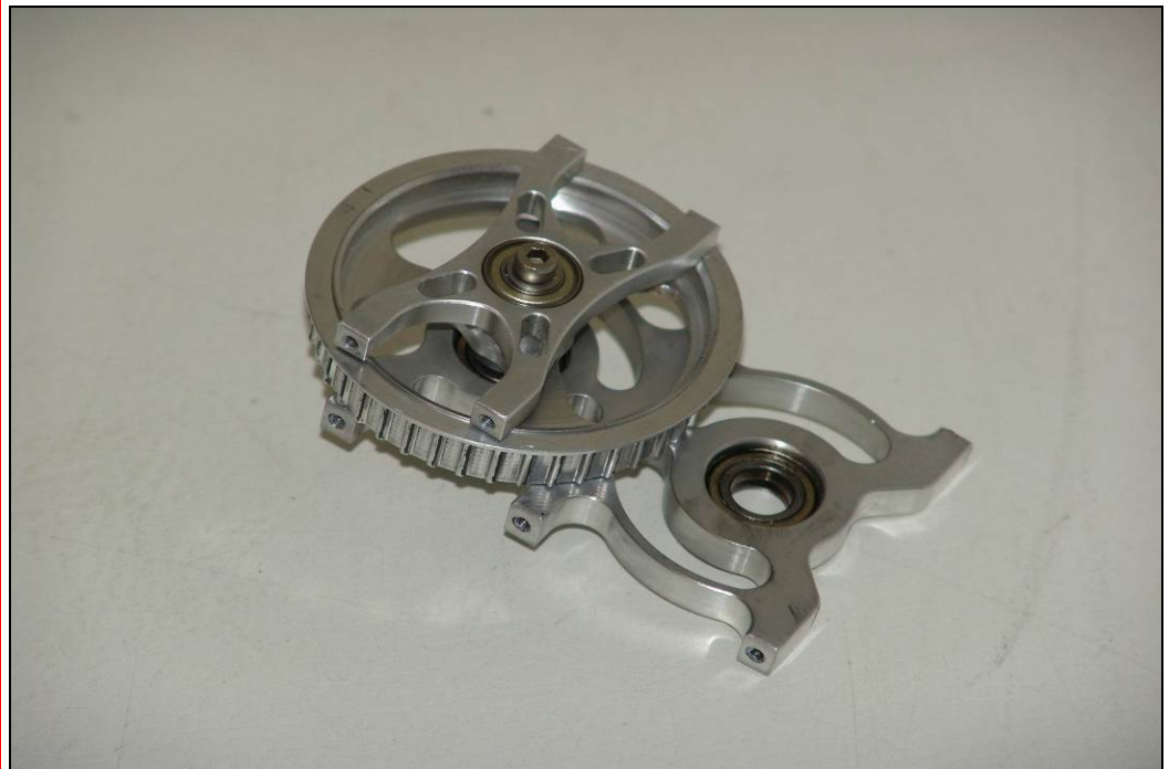
Bild zeigt montiertes Riemenrad und Lagerleiste Zwischenlager
