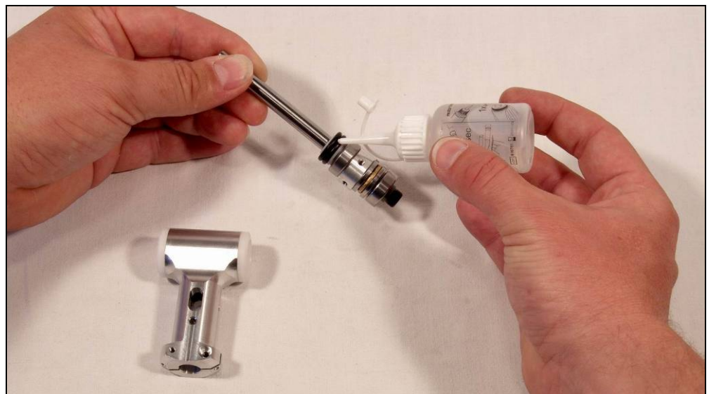
Bild zeigt Schmierung der O-Ringe
